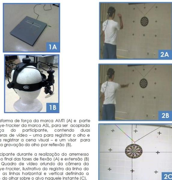
**Fig. 1** Plataforma de força da marca AMTI (A) e parte ótica do eye-tracker da marca ASL, para ser acoplada à cabeça do participante, contendo duas microcâmeras de vídeo – uma para registrar o olho e outra para registrar a cena visual – e um visor para possibilitar a gravação do olho por reflexão (B).
